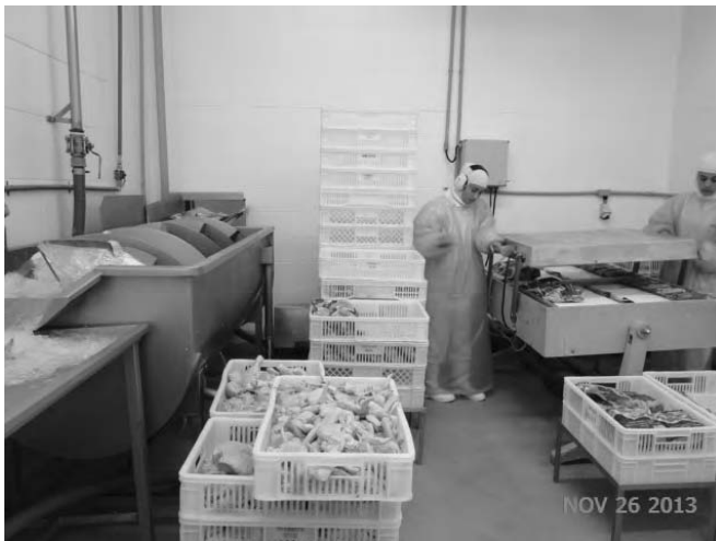
CHILLER DE RECORTES E SELADORA A VACUO
